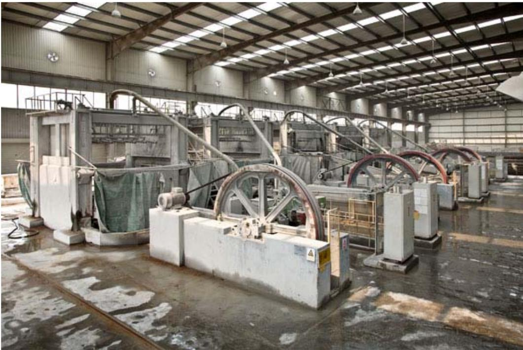
花岗岩砂锯主要由锯框、曲柄连杆、立柱框架、锯条等部件组成，其工作原理为装在锯框上的锯条在连杆的带动下随着锯框作往复运动，同时通过升降传动机构连续向下作进给运动，从而实现对石材的锯切加工。由于砂锯要消耗大量的钢砂和石灰，加工后所产生的大量
