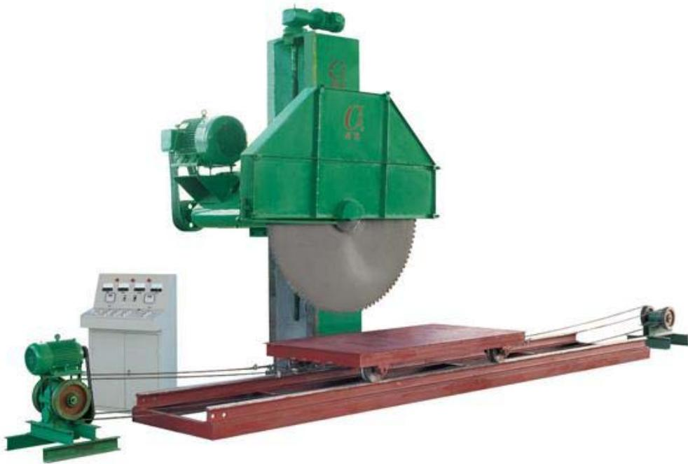
第二类是龙门式圆盘锯机，它的主要结构是由左右两立柱、横梁、滑箱等部件组成，采用横梁上下运动的方法来带动锯片切割石材，此类产品刚性好，但结构复杂，造价较高；
