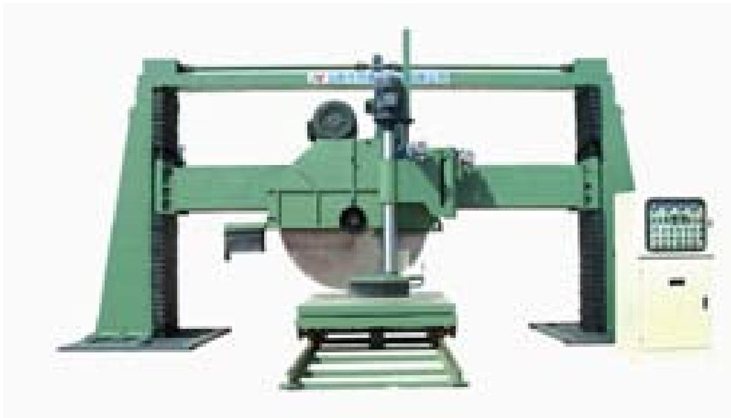
第三类是桥式圆盘锯机，它的主要结构由横梁和纵使滑箱组成，彩滑板上下运行的方法带动锯片来石材，产品结构简单、造价低，适
